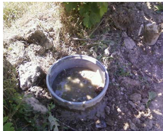
Modalité « Travail du sol » : problème d'étanchéité : résurgence de l'eau sous le cylindre
