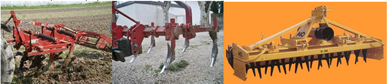
Photo 1 : Outils de travail du sol utilisés dans la modalité classique. De gauche à droite: Bio 2000, griffon et herse rotative
