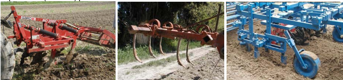
Photo 2 : Outils de travail du sol utilisés dans les planches permanentes. De gauche à droite; Bio 2000, cultivateur à dents et MTCS
