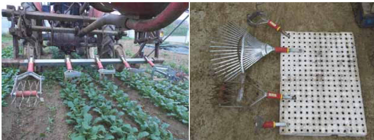
Figure 1 : Barre porte outil et outils amovibles Figure 2 : Gamme d'outils utilisés sur la ferme
