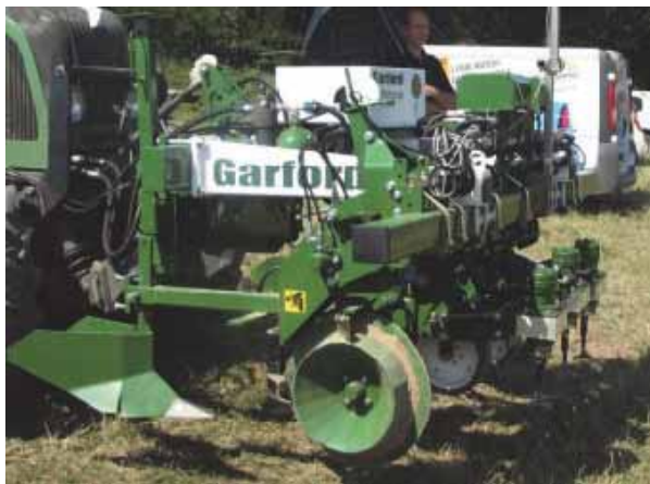
Figure 4. Bineuse à disques rotatifs Robocrop Inrow
