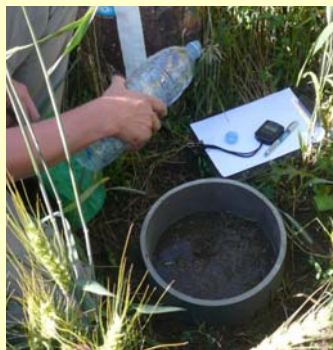
Figure 4 : Verser le volume d'eau. Chronométrer jusqu'au ressuyage complet de l'eau. Répéter l'opération.
