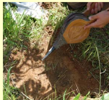
Figure 1b : ...rafraîchir à l'aide d'un soufflet la surface raclée.
